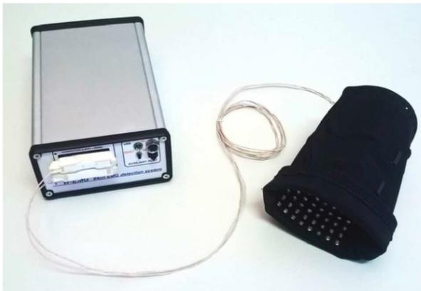
(d) Flexible mylar array with double adhesive foam.
